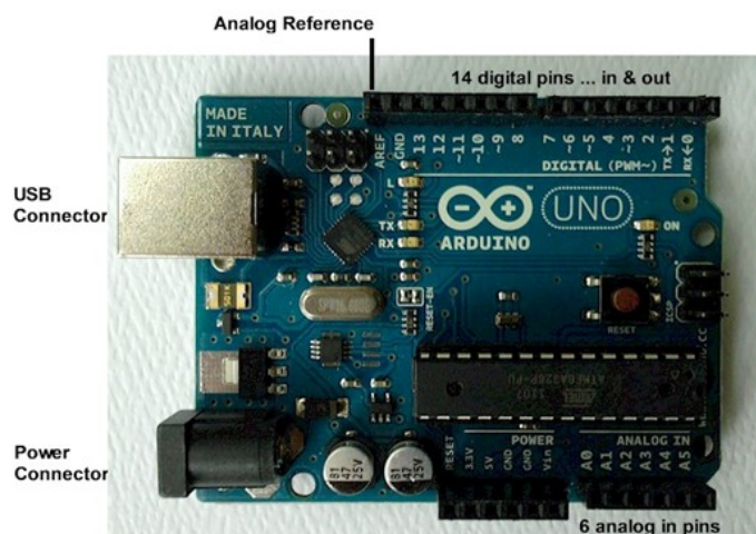
Εικόνα 2: Διάγραμμα της πλακέτας Arduino Uno Rev3 που απεικονίζει τα κυριότερα εξαρτήματα της πλακέτας.
